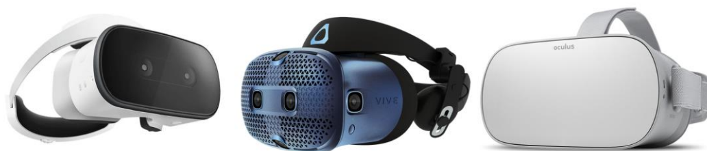
Figure 12: Systèmes de RV permettant la RM, (a) Lenovo, (b) HTC Vive Pro, et ne permettant pas la RM, (c) Oculus Go.
