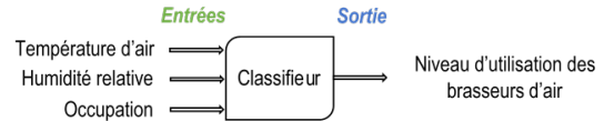
FIGURE 3.17 – Modèle 2 : Description du modèle pour l'estimation du niveau d'utilisation des BA. Notez que le classifieur peut être une régression logistique (RL), un arbre de décision (DT), une forêt aléatoire (RF) ou un réseau bayésien (BN).
