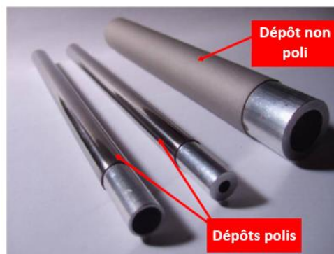
Figure 14 : Tuyaux en aluminium revêtus d'un dépôt de verre métallique (avant ou sans polissage) (adapté de [5]).
