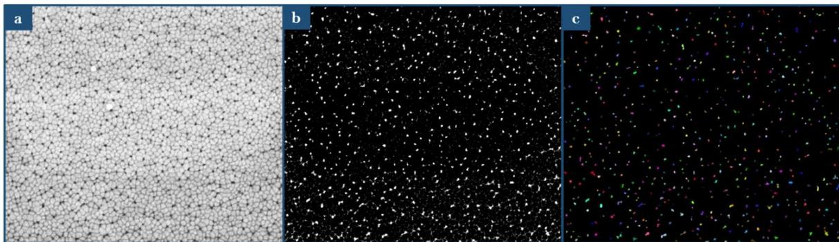
*Figure 41 : a) Image SEM d'une zone irradiée d'une couche mince de verre métallique Zr-Cu. b) Seuillage binaire de la photo présentée en a. c) Sélection d'une taille minimale de groupes de pixels blancs.*
