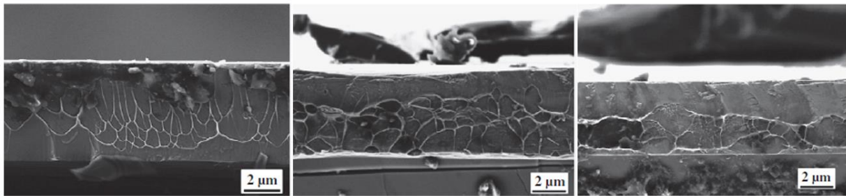
Figure 11 : Photographies SEM de coupes transversales de dépôts de verres métalliques Zr-Cu présentant diverses compositions [14].
