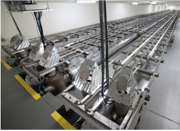
(a) Les six lignes à retard de CHARA. Les six blocs en entrée comportent une paire de miroir en configuration périscope pour envoyer les faisceaux vers les chariots en butée au fond de la salle.
