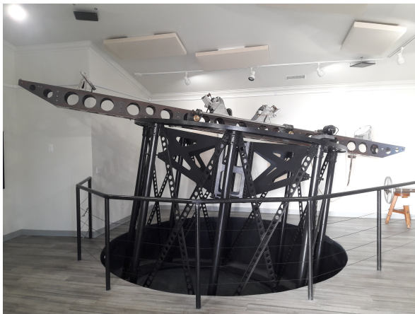
Figure 1.8 – Poutre de Michelson ayant permis pour la première fois la mesure du diamètre de Bételgeuse et de huit autre étoiles par la suite. Deux miroirs plans montés sur des rails sont orientés à 45° pour envoyer la lumière vers deux autres miroirs plans centraux réfléchissant la lumière vers le bas où se trouve le miroir de 1.5 m du télescope. La structure métallique cylindrique est le tube porteur du miroir secondaire du télescope. Photographie prise sur le site du Mont Wilson où il est exposé, lors de la mission d'intégration de l'instrument SPICA-VIS en 2022.
