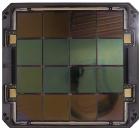
(a) Plan focal de la caméra ZTF (BELLM et al., 2019b).
