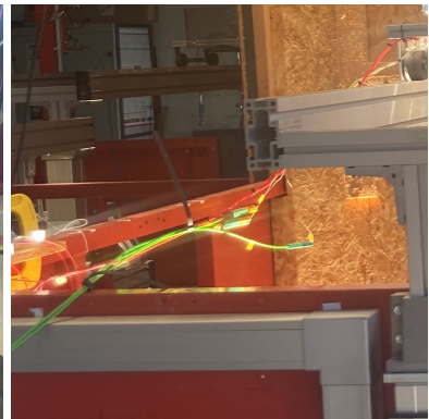
(f) Fixation des câbles des thermocouples.
