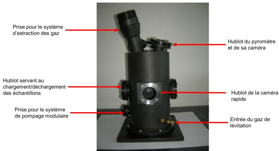
Figure 6-1: Chambre de confinement du banc ATTILHA
