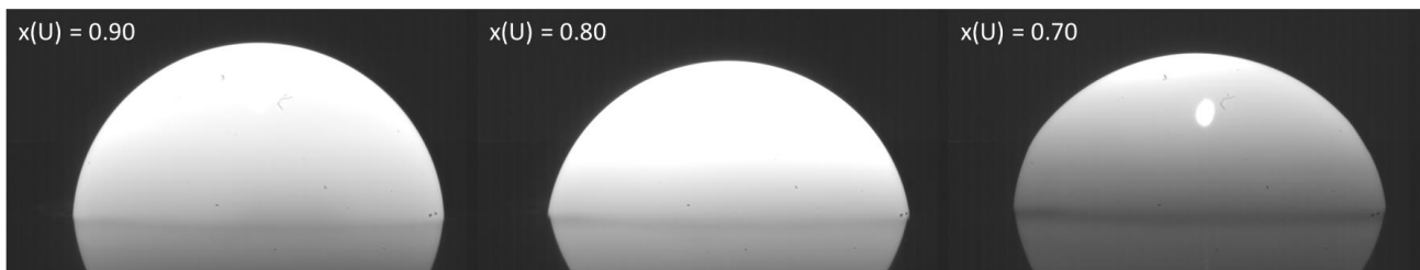
Figure 6-21: Images issues des acquisitions vidéos des gouttelettes liquides Zr-UO 2 en lévitation aérodynamiques
