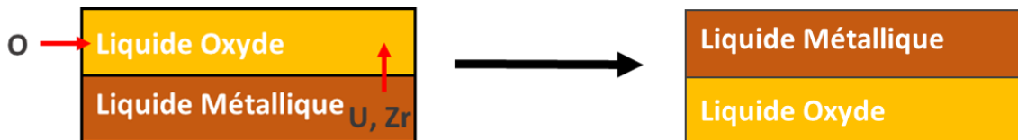
Figure 5-45: Schéma de l'effet de la quantité d'oxygène sur la stratification du corium d'après le calcul. L'oxygène se relocaliserait dans le liquide oxyde, provoquant une migration de l'uranium et du zirconium du liquide métallique vers le liquide oxyde. Le liquide métallique se retrouverait appauvri en éléments lourds, diminuant sa masse volumique et menant à une inversion de la stratification du corium.
