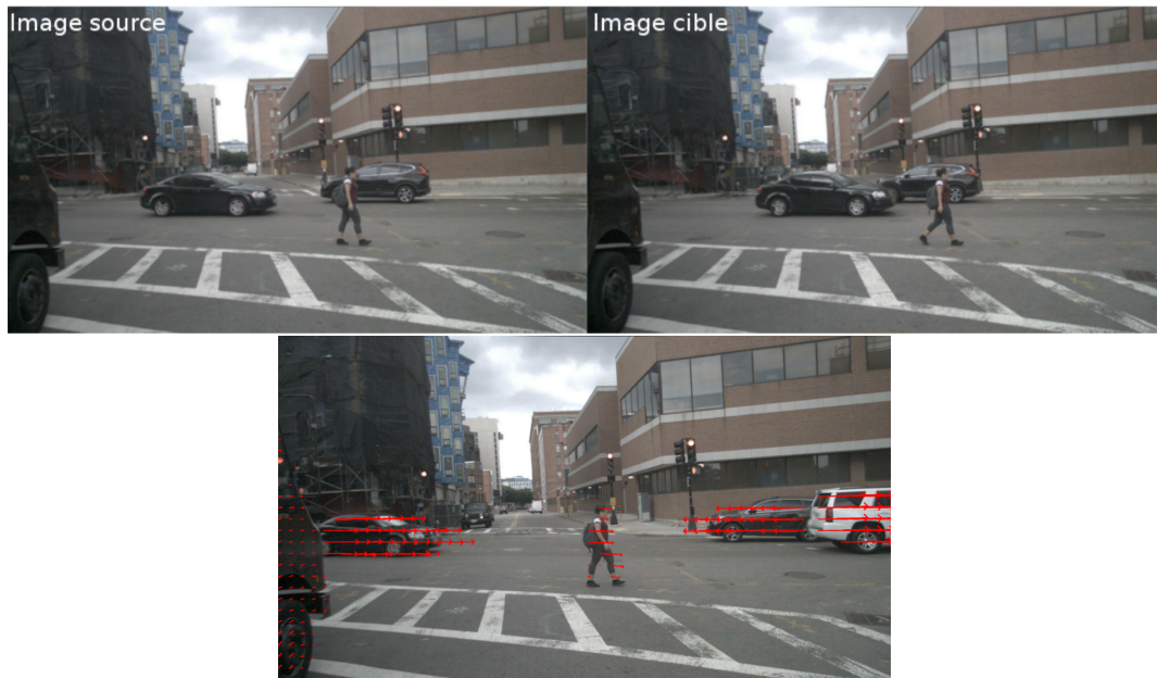
FIGURE 29 – Estimation du flot optique entre deux instants consécutifs. Les objets mobiles comportent des vecteurs de déplacement rouges. Images issues du jeu de données nuScenes (CAESAR et al., 2020).
