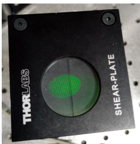
FIGURE 3.18 – Photographie de l'interféromètre à dédoublement ( shear plate ) après alignement du montage 4f d'imagerie.
