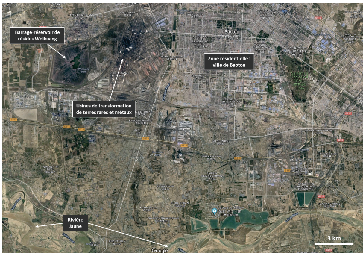
Figure 19. Vue aérienne (Google maps satellites) de la région de Baotou, avec l'usine de traitement de TR, le bassin d'effluents et la proximité de la rivière Jaune
