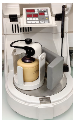
Figure 120. Photographie du broyeur planétaire avec le bol en zircone
