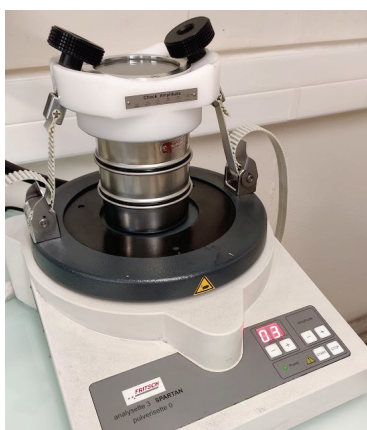
Figure 121. Photographie de la tamiseuse à vibration
