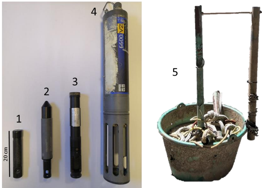
Figure 2. 5. Sondes et bâti de support déployés pour l'échantillonnage continu. 1 : sonde conductivité HOBO ; 2 : sonde OD HOBO ; 3 : sonde turbidité STBD ; 4 : sonde YSI avec capteur conductivité ; 5 : bâti support.
