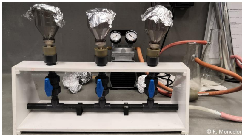
Figure 2. 9. Rampe de filtration utilisée pour la mesure de biomasse chlorophyllienne et de phéopigments.
