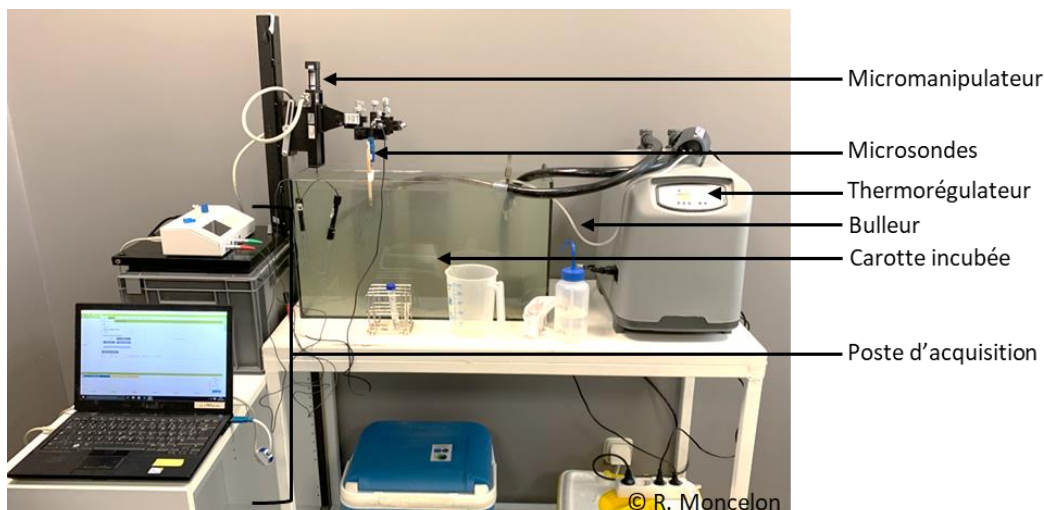
Figure 2. 12. Dispositif de microprofilage ex situ .
