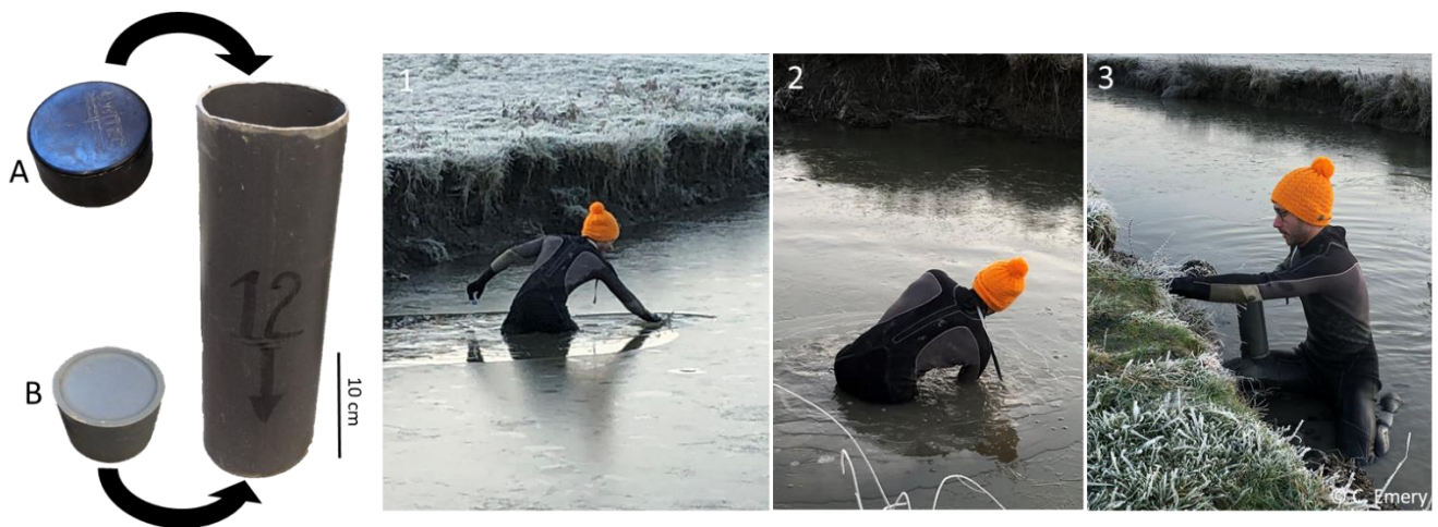
Figure 2. 8. Outils de prélèvement de carottes et action de prélèvement (Genouillé, hiver 2021).
