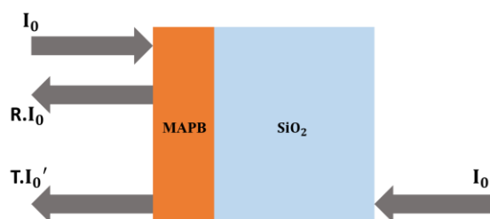
Figure 30 Schéma de la mesure de réflectivité et transmission à travers une couche de pérovskite MAPB
