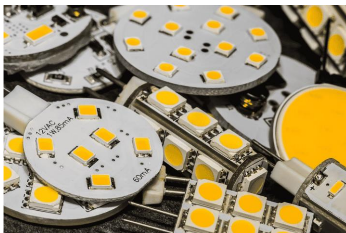
Figure 5 LED blanche à base de GaN et de phosphore.
