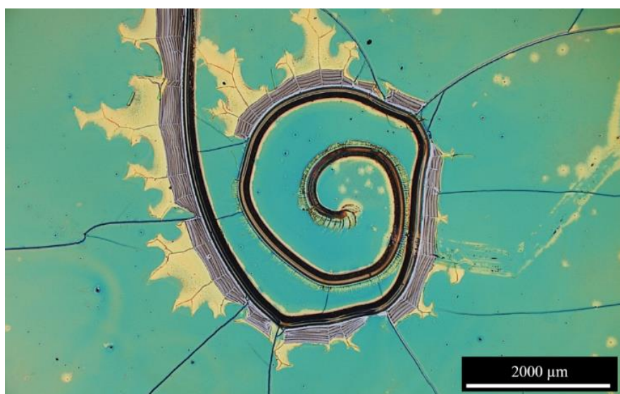
Figure 21 Large craquelure en forme de spirale dans le MAPB observée après enduction centrifuge et cristallisation.
