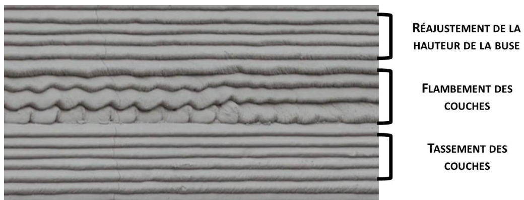
Fig. 2.22 : Variation de la distance d'écartement de la buse causée par le tassement des couches imprimées
