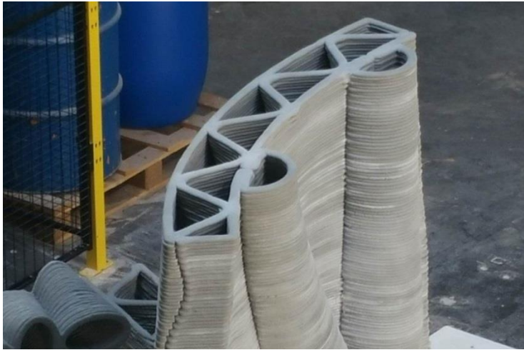
Fig. 1.5 : Mur imprimé en 3D [13]
