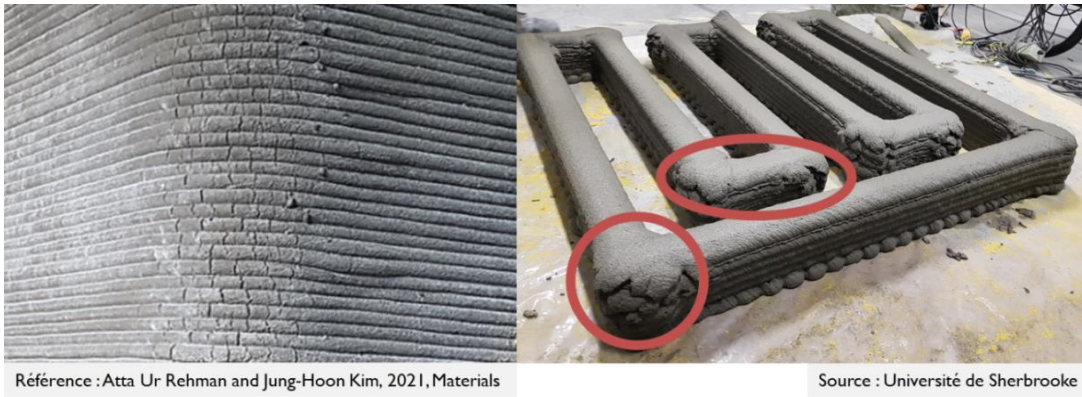
Fig. 2.25 : Problèmes dus à un mauvais ajustement de vitesse de transition
