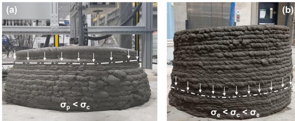
Fig. 4.13 : (a) Rupture plastique du mortier M1 ; (b) Rupture par flambement élastoplastique du mortier M3 (La ligne en pointillée limite les zones élastique et plastique)
