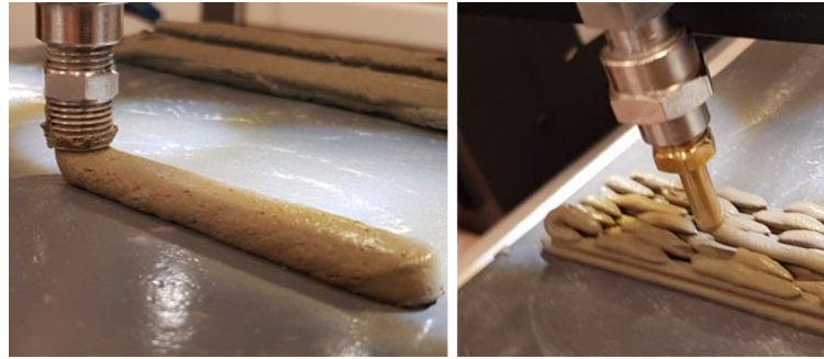
Fig. 1.10 : À gauche : bonne qualité d'extrusion du matériau ; à droite : mauvaise extrudabilité reflétée par une discontinuité de filament
