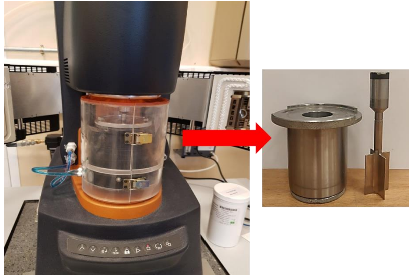
Fig. 2.7 : Le Rhéomètre DHR2 et la géométrie de mesure utilisés
