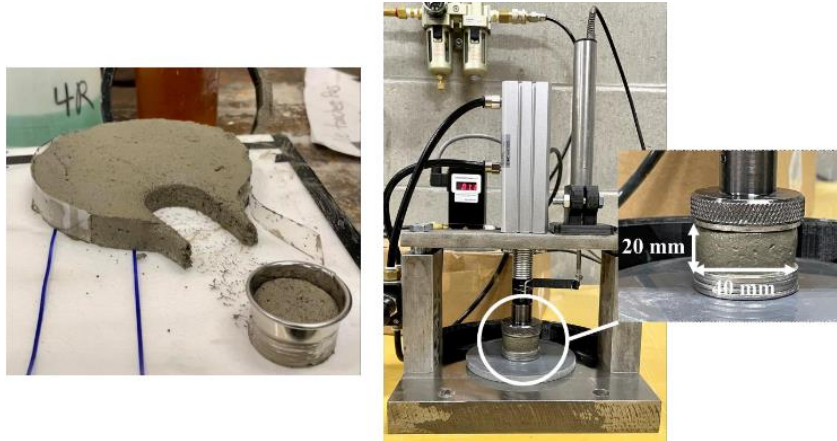
Fig. 4.8 : Dispositif du squeeze test développé à l'Université de Sherbrooke
