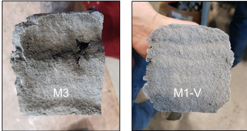
Fig. 4.19 : Faciès de rupture lors de l'essai de flexion des éprouvettes imprimées des mortiers M1-V et M3
