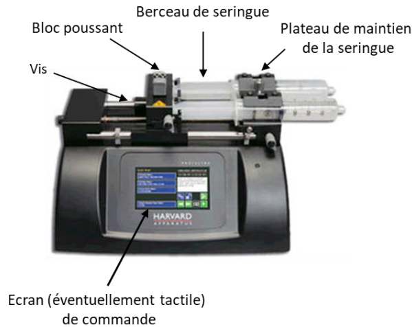
Figure 21 : Principe de fonctionnement d'un pousse-seringue
