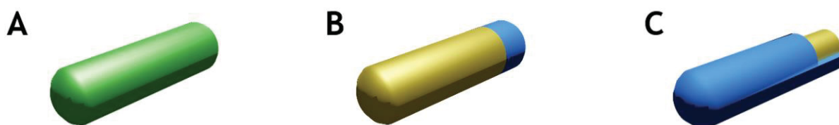
Figure 92 : Différentes architectures de nanostructures bimétalliques décrites dans la littérature : A) nanoalliages ordonnés ou désordonnés ; B) nanoalliages ségrégés ; C) cœur@coquille.
