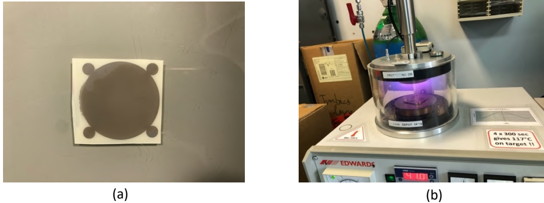
Figure 91 : (a) Échantillon de matériaux FDC Epoxy-SiC. (b) Métallisation de l'échantillon.
