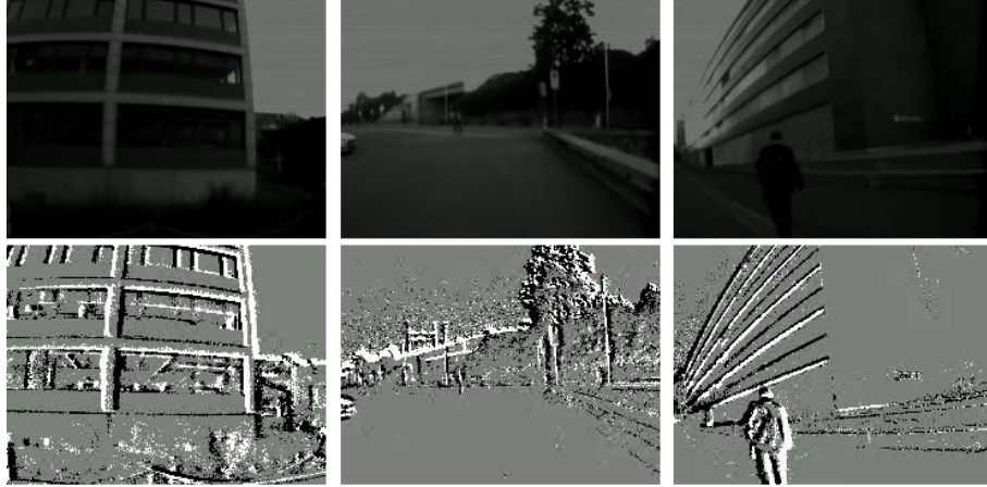
FIGURE 4.7 – Le jeu de données de locomotion urbaine utilisé et capturé par [Mueggler et al., 2017]. La scène a été capturée simultanément par une caméra classique et une caméra événementielle. La ligne du haut montre la scène capturée par la caméra classique tandis que celle du bas montre les événements générés par la capture de la scène à l’aide d’une caméra événementielle. Chaque colonne représente le même instant temporel pour les deux caméras.
