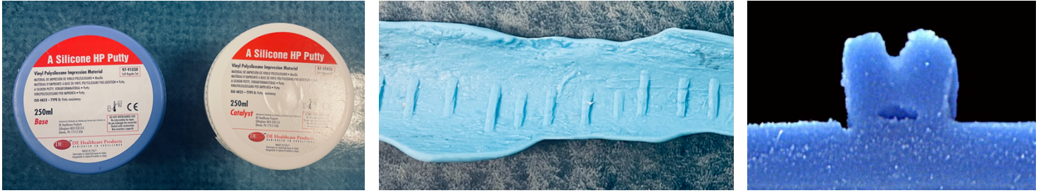
Figure 18 : Pâte dentaire habituellement utilisée pour réaliser le moulage de faux départs. (a) Silicone HP Putty® (b) plusieurs moulages de faux départs (c) visualisation facilitée d'un profil de faux départ, par observation du moulage au stéréomicroscope
