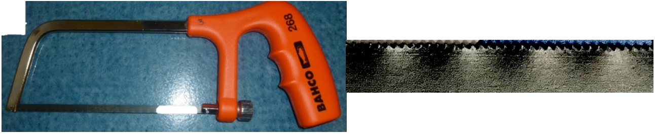
Figure 45 : (a) scie à métaux utilisée pour produire les faux départs (b) lame de la scie utilisée
