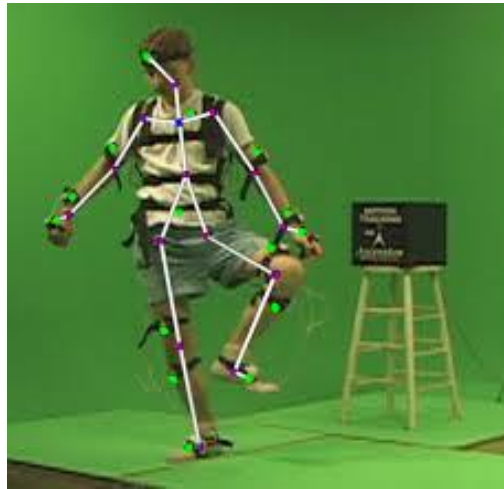
Figure 3.14 – Exemple de capture de mouvement magnétique de la marque Ascension et un modèle squelettique associé (O'Brien et al. 2000 : 53)
