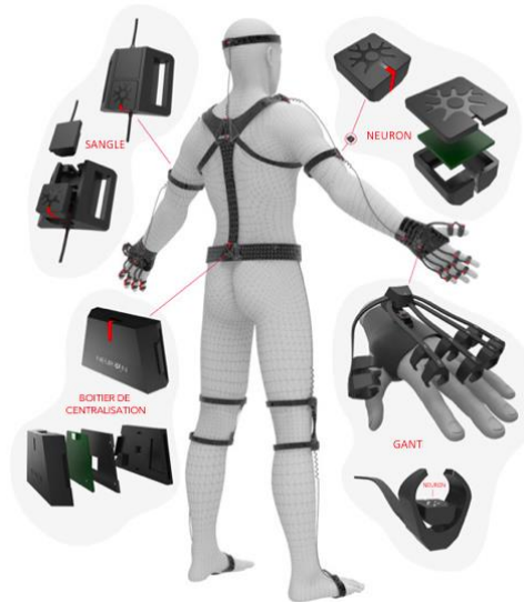
Figure 5.2 – Composantes de la combinaison du Perception Neuron (adapté d'Axis Neuron Userguide 2015 : 44)
