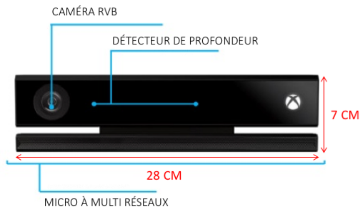
Figure 3.9 – Caractéristiques de la Kinect 2.0
