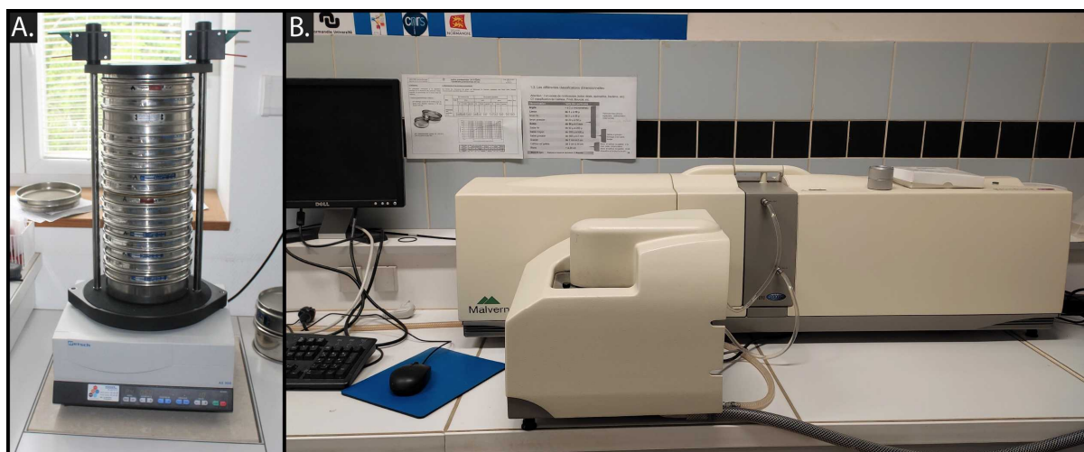
Figure 2.4 - (A) Colonne à tamis et tamiseuse Retsch utilisées pour l'analyse granulométrique ; (B) granulomètre laser Malvern Mastersizer 2000 utilisée pour les tests.
