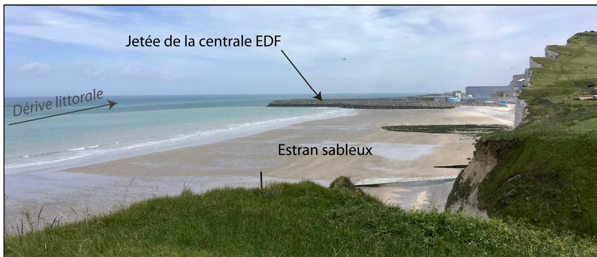
Figure 3.12 - Photographie de la plage de Saint-Martin-en-Campagne, formée par accumulation de sable contre le chenal de la centrale nucléaire EDF de Penly (Cl. B. Peuziat, 2019).
