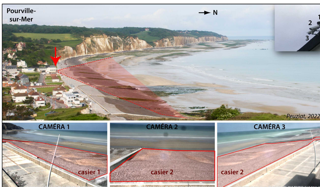
Figure 5.50 – Dispositif des 3 caméras installées à Pourville-sur-Mer.
