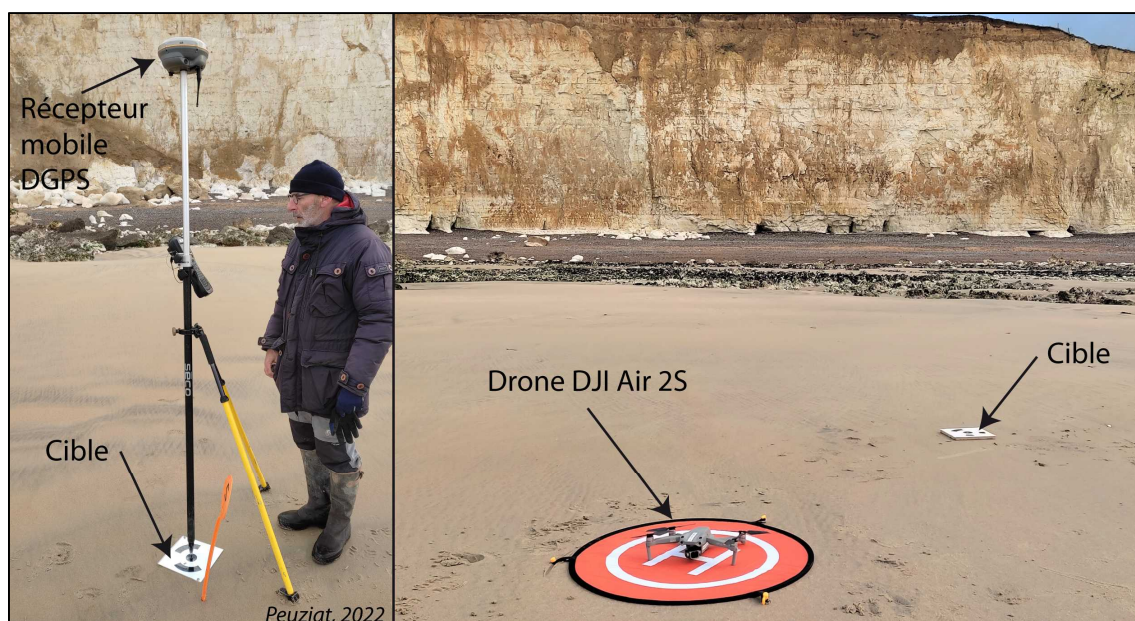
Figure 5.23 - Relevé GPS des cibles pour le géoréférencement des photos aériennes.
