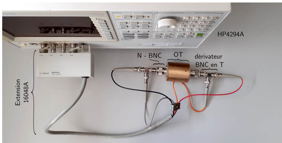
FIGURE 2.10 – Photographie du dispositif OT monté sur l'analyseur d'impédance, pour une mesure de type quatre pointes.
