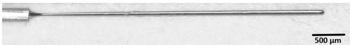
FIGURE 2.17 – Profil du micro-outil en tungstène de diamètre initial de  $250\ \mu\text{m}$  et de longueur plongée de  $5\text{mm}$  gravé dans une solution  $\text{NaOH}$  de concentration de  $4\text{mol/l}$  en température ambiante pour  $Q=13,2\text{C}$ ;  $V_{ON}=0,5\text{V}$ ;  $V_{OFF}=-0,8\text{V}$ ;  $T_{ON}=T_{OFF}=3\text{s}$
