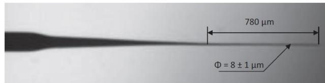
FIGURE 1.21 – Micro-outil en tungstène de  $\Phi=8 \mu\text{m} \pm 1 \mu\text{m}$  et  $F_f=78$  réalisé par gravure électrochimique en utilisant le  $\text{NaOH}$  de  $C=4\text{mol/l}$ , un signal pulsé et une tension de  $5\text{V}$  [21]
