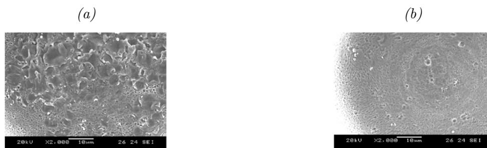
FIGURE 4.31 – État de surface de la pièce après usinage dans le cas d'utilisation de l'eau-déionisée (40V, 5000 pF, 2.5 MΩ cm), profondeur des trous : 30 µm : (a) après usinage (b) 10s après usinage [111]
