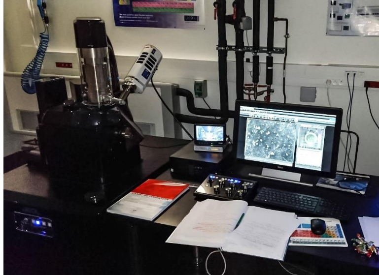
Figure 25 : Microscope électronique à balayage (MEB) de la plateforme CARMALIM de l'Université de Limoges.
