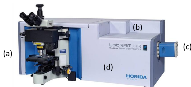
Illustration 1. Micro-spectromètre Raman : (a) microscope confocal (b) source laser (c) détecteurs (d) spectromètre Raman
