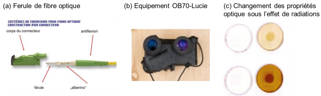
Figure 3. (a) Photo d'un connecteur pour fibre optique (Diamond SA) (b) Equipement officiel de l'armée française, dispositif passif de vision nocturne grossissant (Ministère des armées) (c) Changement des propriétés optiques des matériaux sous l'effet de rayonnement gamma (ESA)
