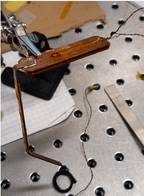
(a) Plaque en cuivre CuA1. Un capteur de température Cernox modèle SD (voir Figure 4.9) est monté dans la plaque.
