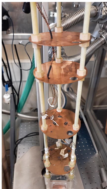
(a) Armature en époxy avec les écrans en cuivre permettant l'insertion des dispositifs de mesure dans le cryostat.
