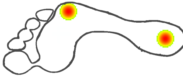
Figure 86 Empreinte d'un pied avec la modélisation de la gaussiennes en 2D pour deux capteurs.
