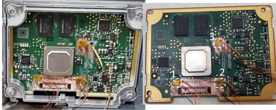
Fig.3.3 Amplasamentul mărcilor tensometrice pe PCB
