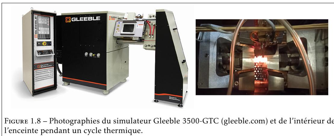
FIGURE 1.8 – Photographies du simulateur Gleeble 3500-GTC (gleeble.com) et de l'intérieur de l'enceinte pendant un cycle thermique.
