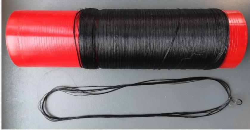
Figure 48 : Photo d'un multifilament  $PET_{NTC}/PBT$  réalisé par le pilote de filage en voie fondue SPINBOY I
