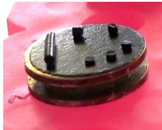
Figure 53 : Préparation des échantillons par cryofracture
