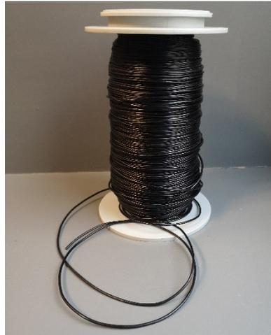
Figure 42 : Photo d'un monofilament d'élastomère chargé mis en œuvre par l'extrusion Process 11
