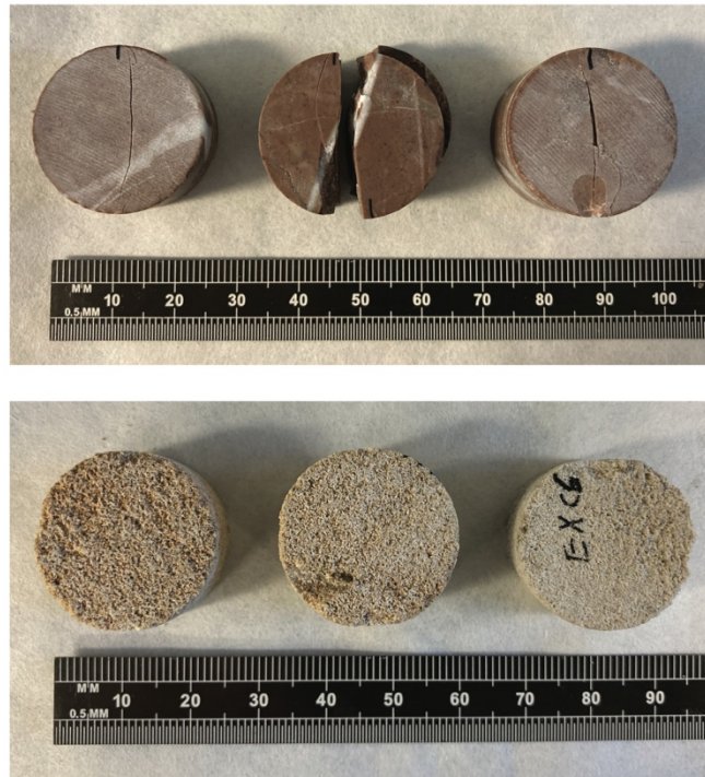
Figure 81. Échantillons de DEL.B et EX après les essais brésiliens. En haut, les calcaires durs se fendent très distinctement ; en bas, la dune oolithique s'écrase et la fissure est très peu visible.
