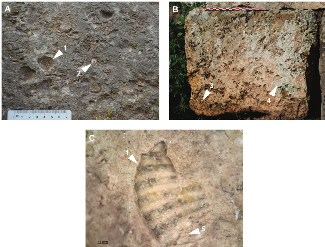
Figure 104. Le calcaire de Mégare : mise en œuvre et description macroscopique.
