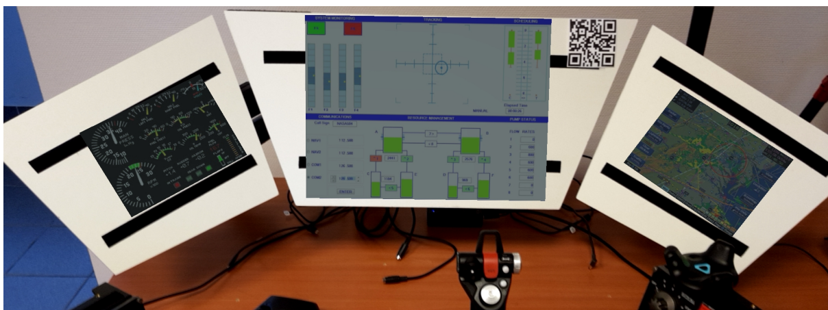
FIGURE 3.3 – Notre plateforme physique et l'EV (ici projeté dans un casque de RA). Les écrans sont placés en fonction de la position du tracker et le pilote peut contrôler l'avion à l'aide des interacteurs tangibles et de la voix.
