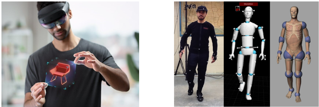
FIGURE 2.10 – Exemples d'interacteurs de type GestureController dont le périphérique de capture est basé sur un casque de Réalité Augmentée (à droite) et sur un dispositif de capture de mouvements (à gauche)
