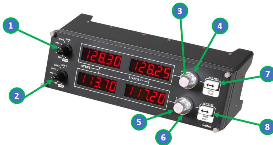
FIGURE A.1 – Dispositif de contrôle radio
