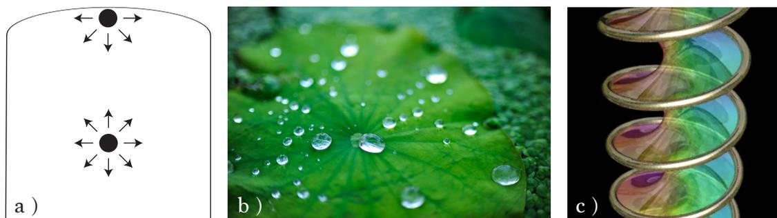
FIGURE 1.1 – Représentation schématique des interactions attractives d’une molécule en volume et à l’interface d’un liquide (a). Photographies d’illustrations de la minimisation de surface par des effets de tension superficielle. (b) Photographie de gouttes d’eau à la surface d’une feuille hydrophobe. (c) Film savonneux hélicoïdal.
