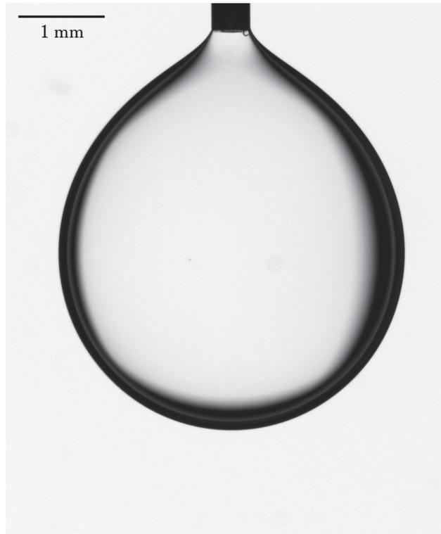
FIGURE 4.1 – Photographie d'une goutte d'eau avec du TTAB à 4CMC dans un bain d'huile 500M.
