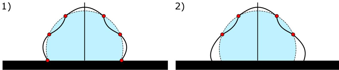
FIGURE 1.16 – Les deux comportements d'une goutte sous l'effet de vibrations verticales.
