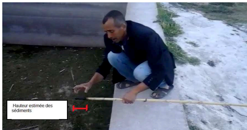
Figure 36 - Estimation de volume des sédiments du récipient (Source : auteur)
