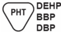
Figure 40 : Symbole indiquant la présence de phtalates CMR dans les dispositifs médicaux, cas pour le DEHP, le BBP et le DBP
