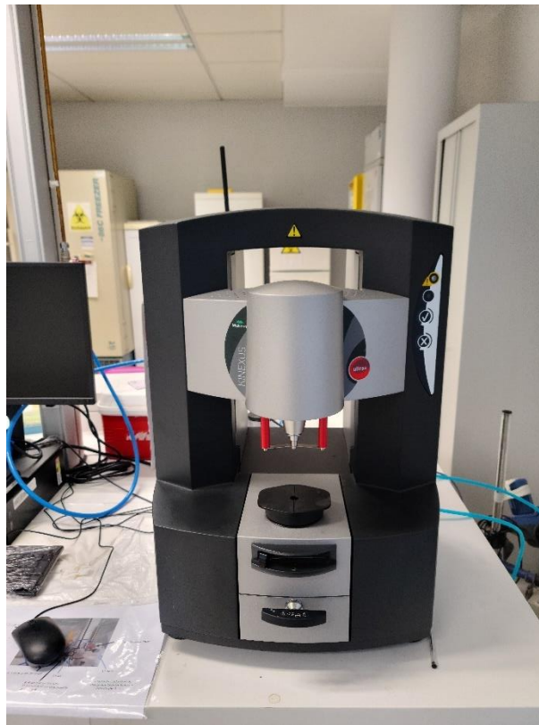
Figure 5: Photographie du rhéomètre employé pour la conduite des expériences de rhéologie.
