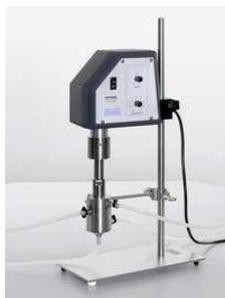
*Figure 2-30 : Dispositif de sonication utilisé.*
