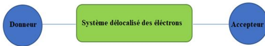
Figure 1-5 : Structure d'un chromophore qui est formé d'un groupement donneur et accepteur séparés par un système délocalisé des électrons.
