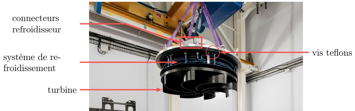
Figure 3.9 – Présentation du système de refroidissement au dessus de la turbine haute. Ce système de refroidissement en cuivre est rempli d'éthylène glycole et connecté au refroidisseur Hubert<sup>©</sup>. ©Y.Audic/CEA.
