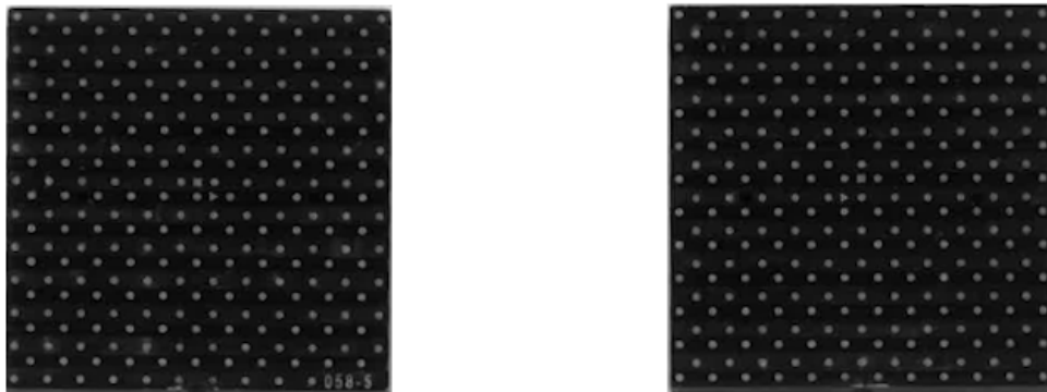
Figure 3.20 – Les deux faces de la mire de calibration utilisée, type “058-S”. On remarquera également le triangle et le carré sur chaque face fixant la position de l’origine voir complément d’explications annexe A partie A.2.
