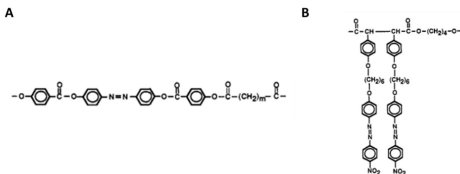
Figure I.24 : Structure de polymères azoïque. A) Groupe azoïque sur la chaîne principale B) Groupe azoïque intégrés sur les chaînes pendantes du polymère. 96
