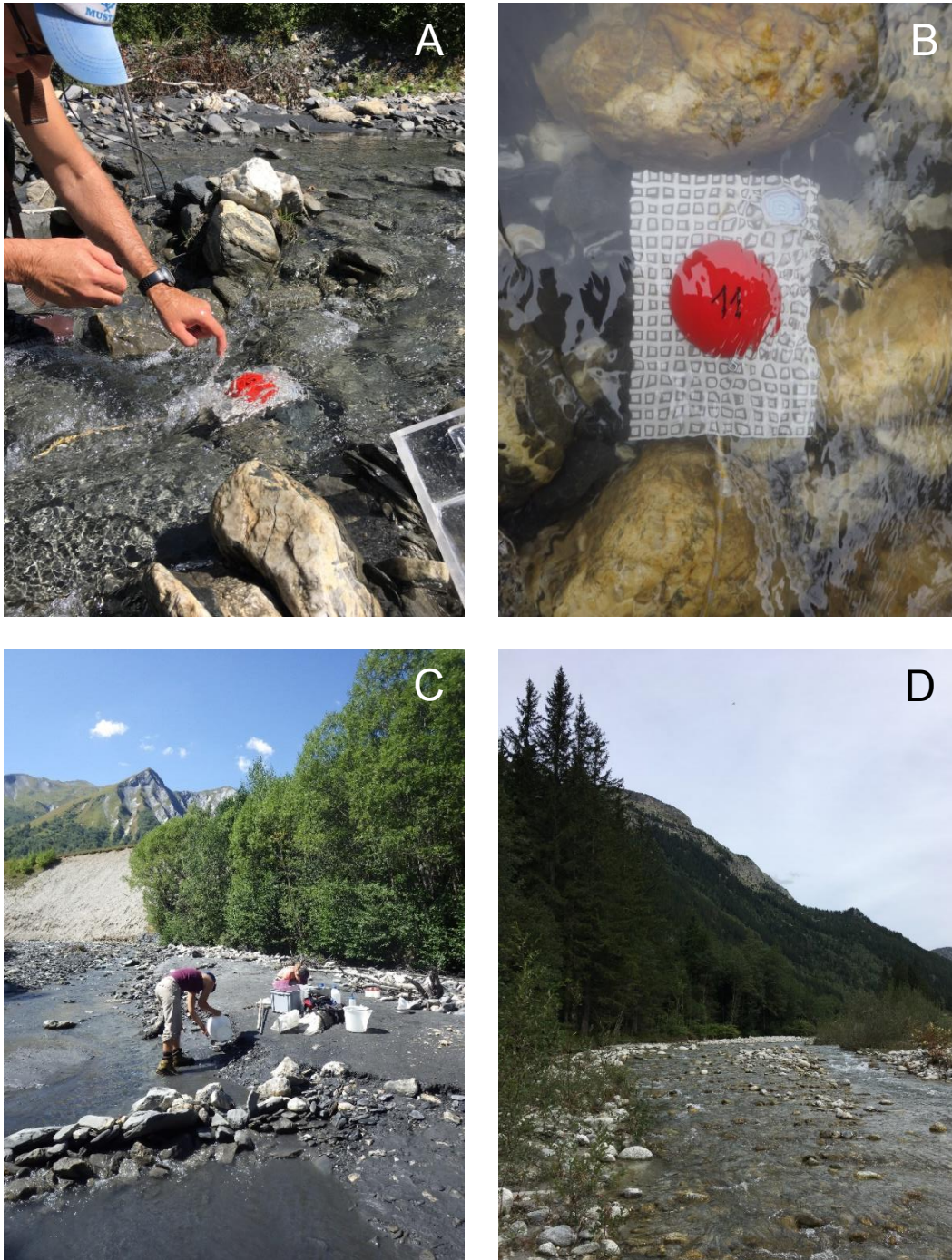
Figure 3 : (A) et (B) Mesure de la contrainte au fond en utilisant des « Fliesswasserstammtisch-hemispheres » (hémisphères HFST), développées par Statzner & Müller (1989). Ces hémisphères, numérotées de 0 à 24, présentant des formes identiques mais des densités différentes, sont tour à tour positionnées sur une plaque en métal disposée à l'horizontal au fond du lit de la rivière. Le numéro de l'hémisphère la plus dense déplacée par le courant est utilisé pour estimer la contrainte au fond (de 0.77 à 712 N.m -2 ). (C) Prélèvements de macroinvertébrés sur le torrent de l'Arvan, 28/08/2019. (D) Arve, site X15, 10/09/2019.
