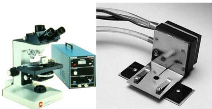
Figure I.2.4 : Platine thermique pour microscope (-20°C - +100°C)<sup>23</sup>
