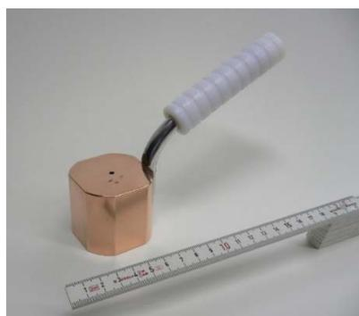
Figure I.2.3 : Système de transport d'échantillon proposé par Stalke
