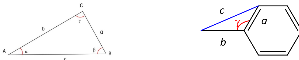
Figure I.3.5 : schéma représentant les distances de liaisons a , b , c et les angles \alpha , \beta , \gamma entre trois atomes de géométrie AX 4 (gauche) ou AX 3 (droite)
