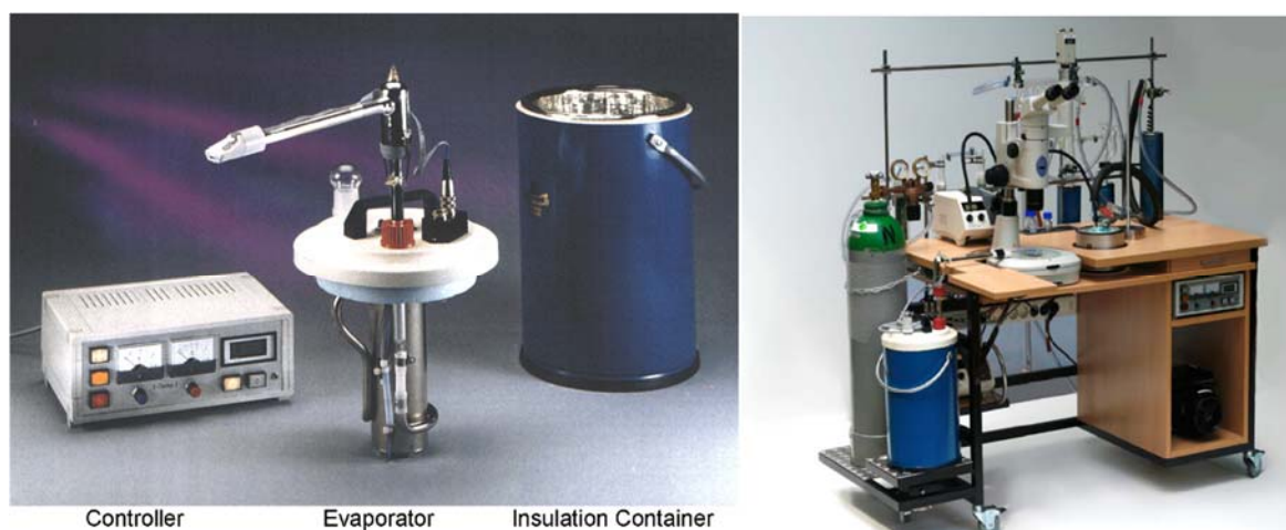
Figure I.2.2 : Système X-Temp2 de chez Stalke : à gauche : éléments séparés, à droite, système complet autour d'un stéréomicroscope et d'un ballon contenant la liqueur mère d'échantillons
