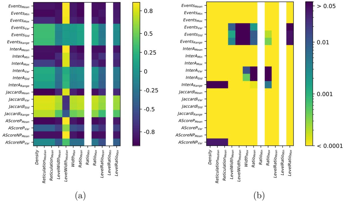
**Figure 6.3** – Heatmap des coefficients de corrélation (a) et p-valeurs (b) des différents critères pour un jeu de 3 ancres et 10 interancres. Les critères calculés sur le graphe sont présentés en abscisse et les critères calculés sur les séquences sont présentés en ordonnée. Les critères  $Ratio_{min}$  et  $LevelRatio_{Min}$  se sont révélés constants et les corrélations n’ont pas été calculées.
