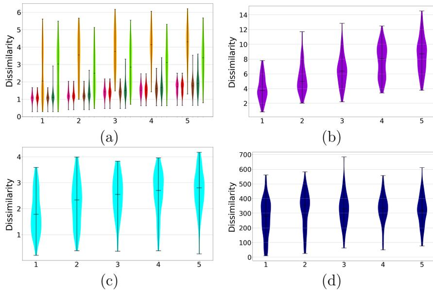
**Figure C.4** – Comparaison des 9 dissimilarités sur le jeu PHMC-LAR ( $w=10$ ) et la perturbation *dilat\_biunif\_e*. En abscisses : degré croissant de perturbation. DTW<sub>x</sub> : DTW<sub>d</sub> : rose ; DTW<sub>c</sub> : rouge ; DTW<sub>f</sub> : orange ; DTW<sub>sc</sub> : marron ; DTW<sub>i</sub> : vert clair ; DTW<sub>m</sub> : vert foncé ; MPDist : bleu clair ; tsfresh : bleu marine ; DFT : violet.
