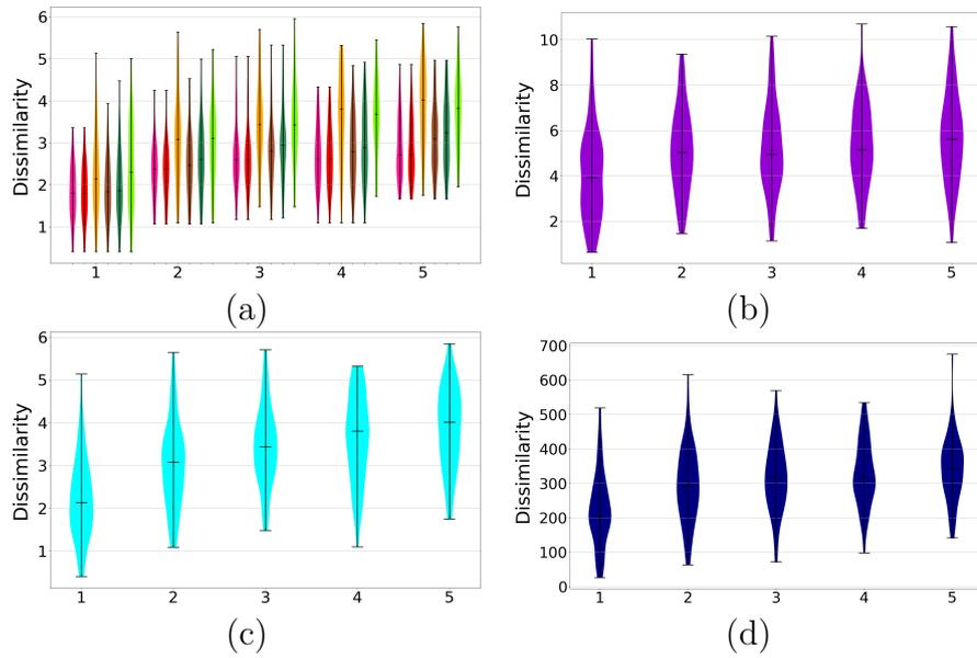
**Figure C.3** – Comparaison des 9 dissimilarités sur le jeu PHMC-LAR ( $w=10$ ) et la perturbation *ampl\_gauss*. En abscisses : degré croissant de perturbation. DTW<sub>x</sub> : DTW<sub>d</sub> : rose ; DTW<sub>c</sub> : rouge ; DTW<sub>f</sub> : orange ; DTW<sub>sc</sub> : marron ; DTW<sub>i</sub> : vert clair ; DTW<sub>m</sub> : vert foncé ; MPDist : bleu clair ; tsfresh : bleu marine ; DFT : violet.
