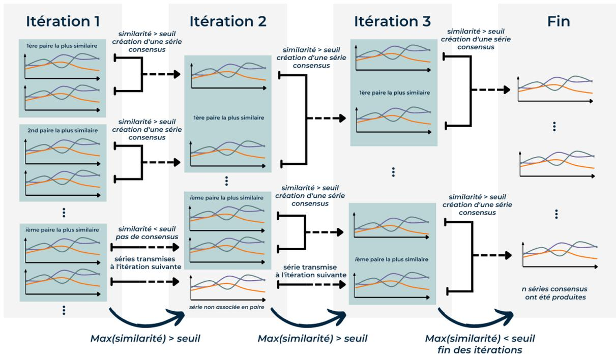
**Figure 6.13** – Schéma de l'enchaînement des différentes itérations pour la création de séries temporelles consensus à partir d'alignement par DTW pour un ensemble de séries temporelles associées entre elles. Les séries consensus produites lors d'une itération sont utilisées à l'itération suivante avec les séries non agglomérées. Les itérations sont répétées tant que la similarité maximale entre deux paires de séries n'est pas inférieure au seuil fixé.
