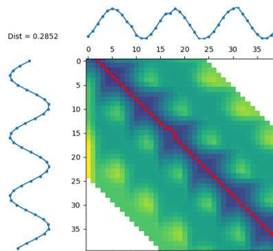
**Figure 4.2** – Matrice d'alignement et chemin minimal pour un alignement de deux séries temporelles sinusoïdales de 40 points. Le chemin d'alignement qui relie la case en haut à gauche de la matrice à la case en bas à droite, est construit par déplacement sans retour en arrière sur les cases de valeurs minimales.
