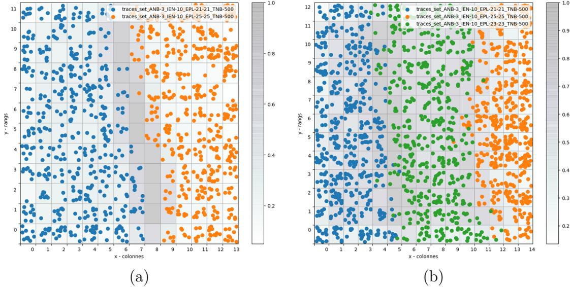
**Figure 6.2** – Résultat du partitionnement pour les jeux A (a) et B (b), présentés en 6.1, et composés respectivement de deux et trois classes. Le fond de la figure présente la U-matrix<sup>5</sup>. Chaque case correspond à un neurone, chaque point dans une case correspond à une séquence associée à ce neurone. La couleur d'un point correspond à sa classe d'origine.
