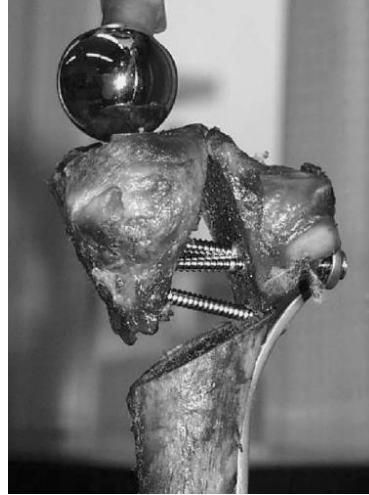
Figure V. 15 : Image issue de l'étude de Dougherty et al., (2008). Cette étude identifie les propriétés biomécaniques associées à l'utilisation de vis uni-corticales comparée aux vis bi-corticales pour la stabilisation avec plaque de fracture de type Schatzker VI
