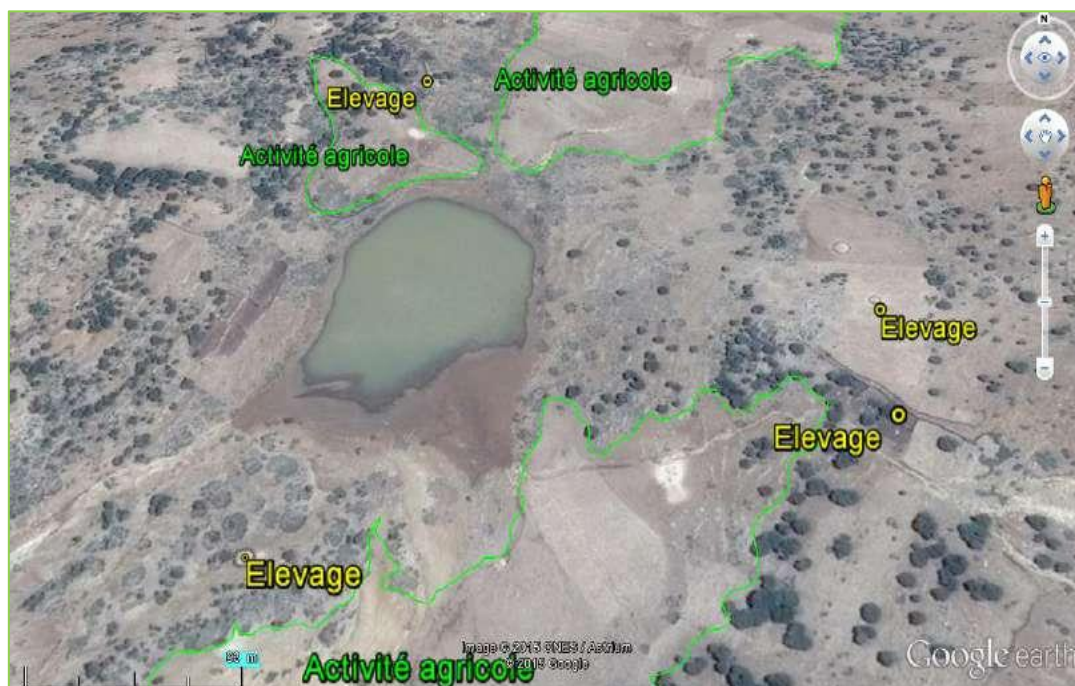
Figure 95: Dysfonctionnement du système karstique à cause de l'anthropisation déforestation et l'élevage (Jabir, 2015)
