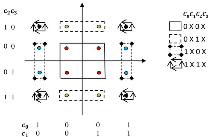
**Figure 2.5 : Constellation 16 QAM avec un mapping de Gray.**
