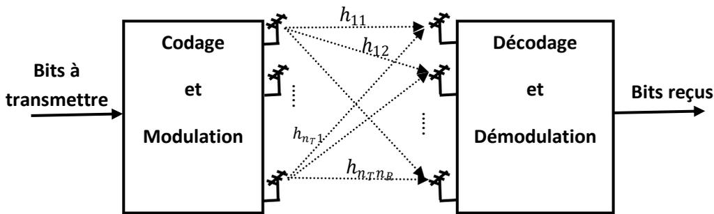
**Figure 1.10 : Schéma d'un système de transmission MIMO.**
