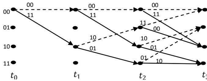
Figure 1.5 : Diagramme en treillis pour le code de la Figure 1.4.
