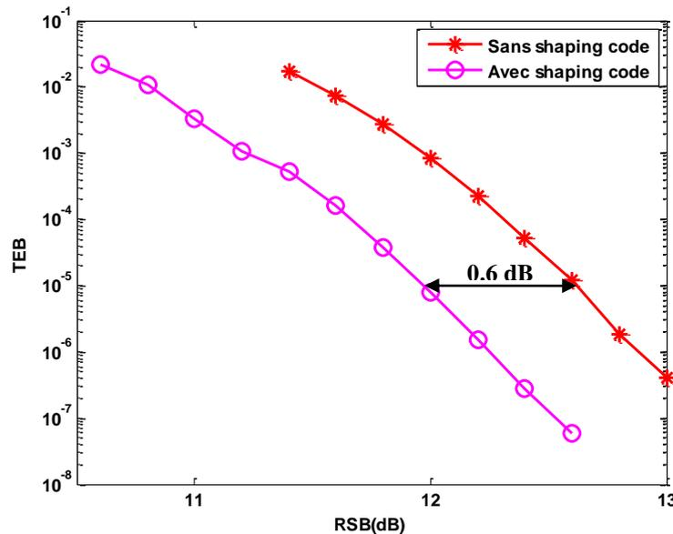
**Figure 2.15 : Comparaison de performances en termes de TEB pour le schéma BICM avec et sans shaping code à travers un canal Gaussien, pour l'efficacité spectrale 4 bit/s/Hz.**
