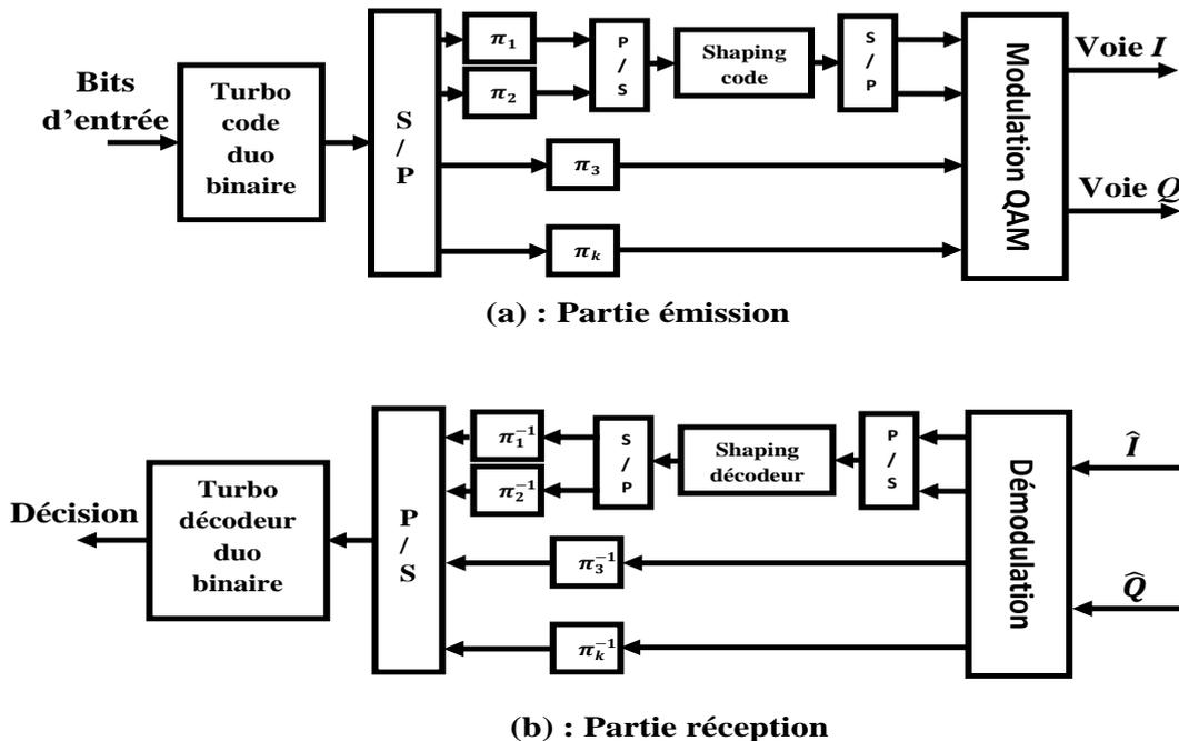
Figure 2.8 : Structure des blocs émetteur-récepteur.
