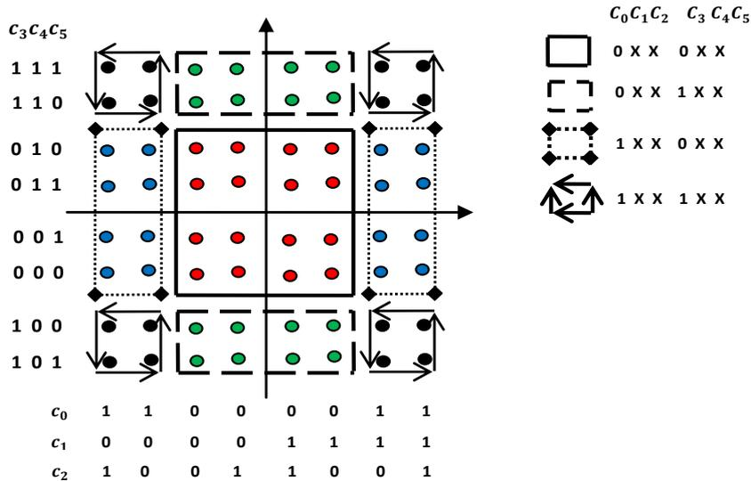
Figure 2.6 : Constellation 64 QAM avec un mapping de Gray
