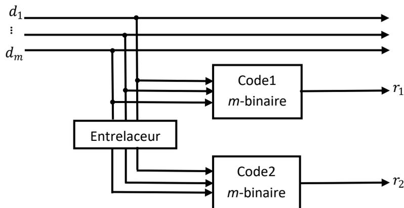
Figure 1.8 : Schéma général d'un turbo code  $m$ -binaire.
