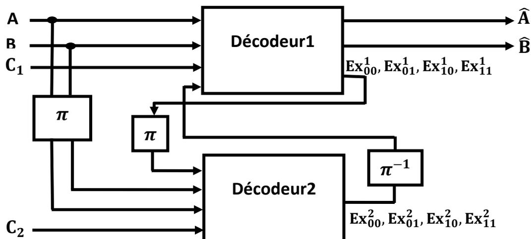
Figure 2.4 : Processus de Turbo décodage duo binaire.
