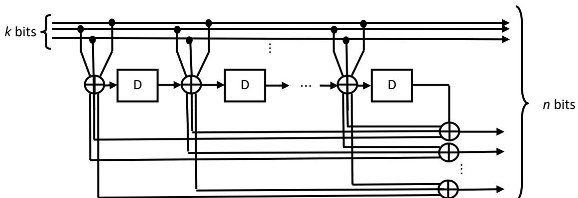
Figure 1.2 : Schéma général d'un code convolutif.
